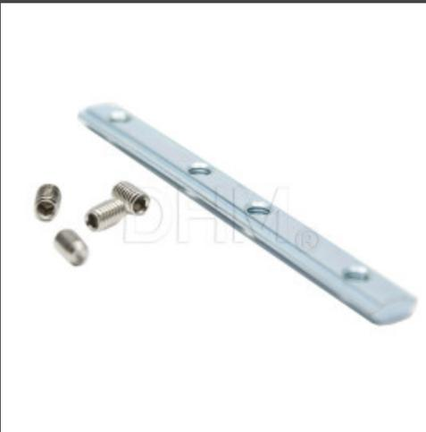
Paket enthält: 1 x Lange Vormontagemutter mit Löchern M5 - 5 Serien Diese Mutter ist für die Verwendung mit stranggepressten Aluminiumprofilen geeignet. Es kann mit Profilen der Serie 5 wie 20x20mm und 20x40mm verwendet werden, die eine 6mm-Nut haben. Sie müssen eingesetzt werden, bevor das Profil montiert wird. Gewindebohrung für die Befestigung der Mutter mit der entsprechenden Schraube. Sie sind für die Befestigung einer Linearführung am Profil geeignet.
