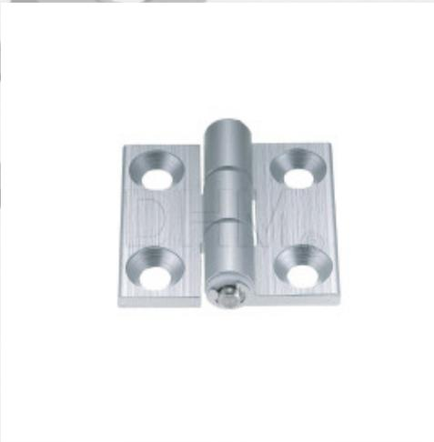
Das Paket enthält: 1 x Scharnier aus eloxiertem Aluminium mit Nylondichtungen Serie 5 Dieses Scharnier aus eloxiertem Aluminium hat Nylondichtungen, um ein Reiben zwischen den Metallteilen des Scharniers beim Öffnen und Schließen zu verhindern. Dieses Scharnier wird mit Aluminiumprofilen der Serie 5 verwendet.
